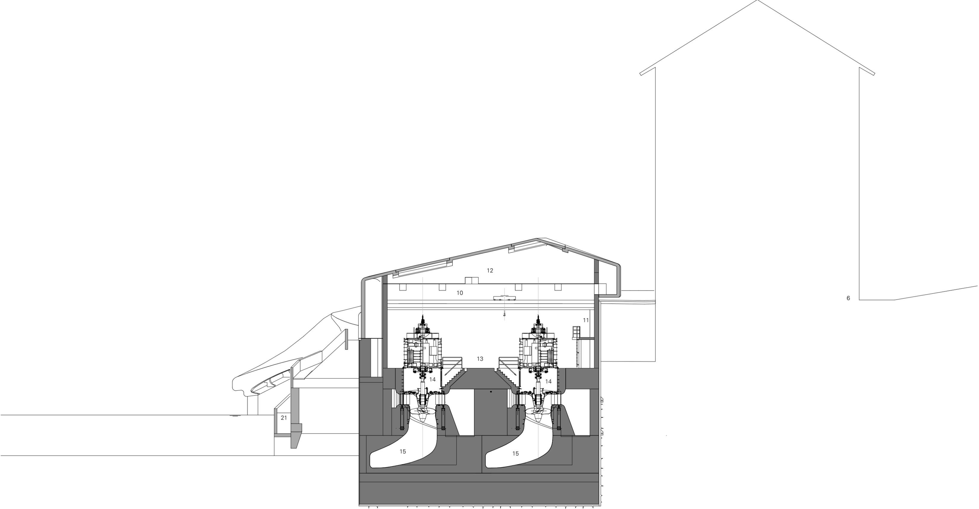
**schnitt quer krafthaus** 6 ehem. weberei 10 kranbahn 11 galerie 12 maschinenraum 13 generatoren 14 turbinen 15 saugschlauch 21 fischtreppe
