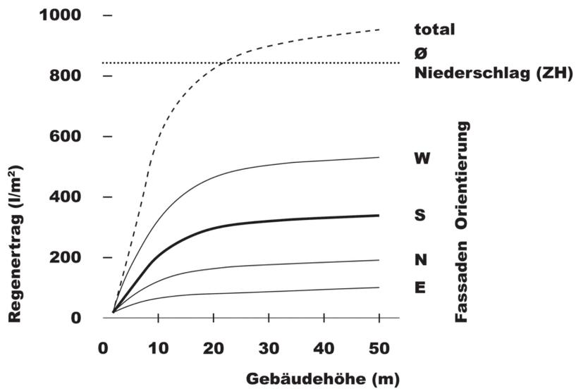
Vertikaler Oberflächen weisen ein beträchtliches Potenzial zur Aufnahme von Regenwasser auf. Deren Aktivierung kann zur signifikanten Verbesserung des innerstädtischen Mikroklimas beitragen.
