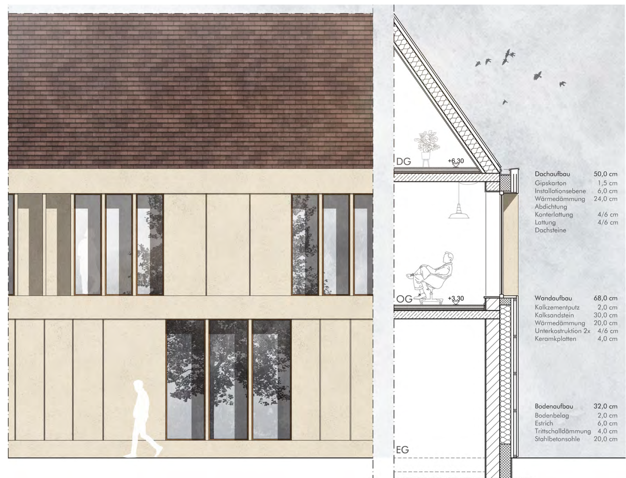
Detailschnitt Verwaltungsbau M 1:50
