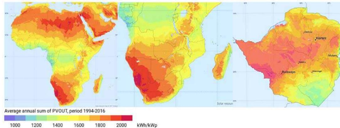
\*kWh/kWp = Kilowattstunde Strom / Höchstleistung in Kilowatt einer Photovoltaikanlage (Kilowatt-Peak)
