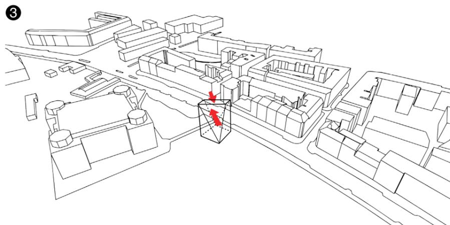
3 Zurücksetzung der oberen Ecken - dadurch Verjüngung nach oben (Anlehnung an den Leuchtturm)
