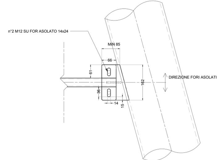
D Dettaglio ancoraggio tubolari secondari
