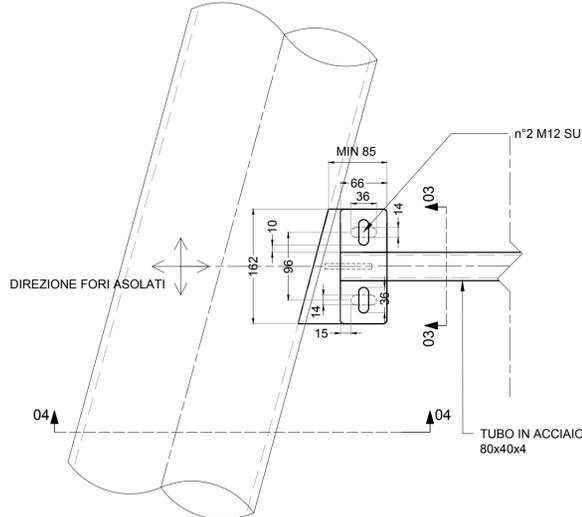
C Dettaglio ancoraggio tubolari secondari
