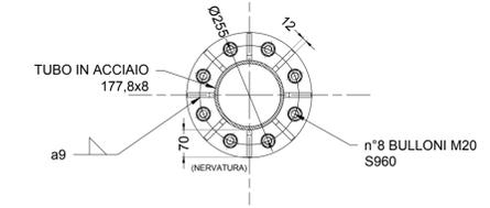
**C** DETTAGLIO CONNESSIONE
