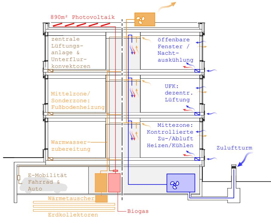
Photovoltaik und ein Blockheizkraftwerk betrieben mit Biogas, versorgen das Gebäude. Unterflurkonvektoren und Fundament-Wärmetauscher regulieren Heizung, Kühlung und die Warmwasserzubereitung. Die Innenbereiche werden über eine kontrollierte Zu- und Abluft belüftet, gekühlt und geheizt. In den Open Space-Bereichen sorgen Unterflurkonvektoren für Frischluft.
