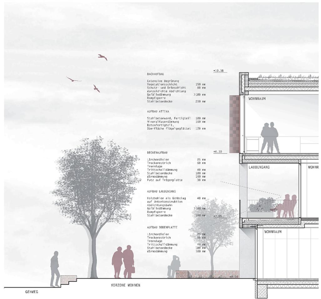
FASSADENSCHNITT NEUBAU \_ M 1:50
