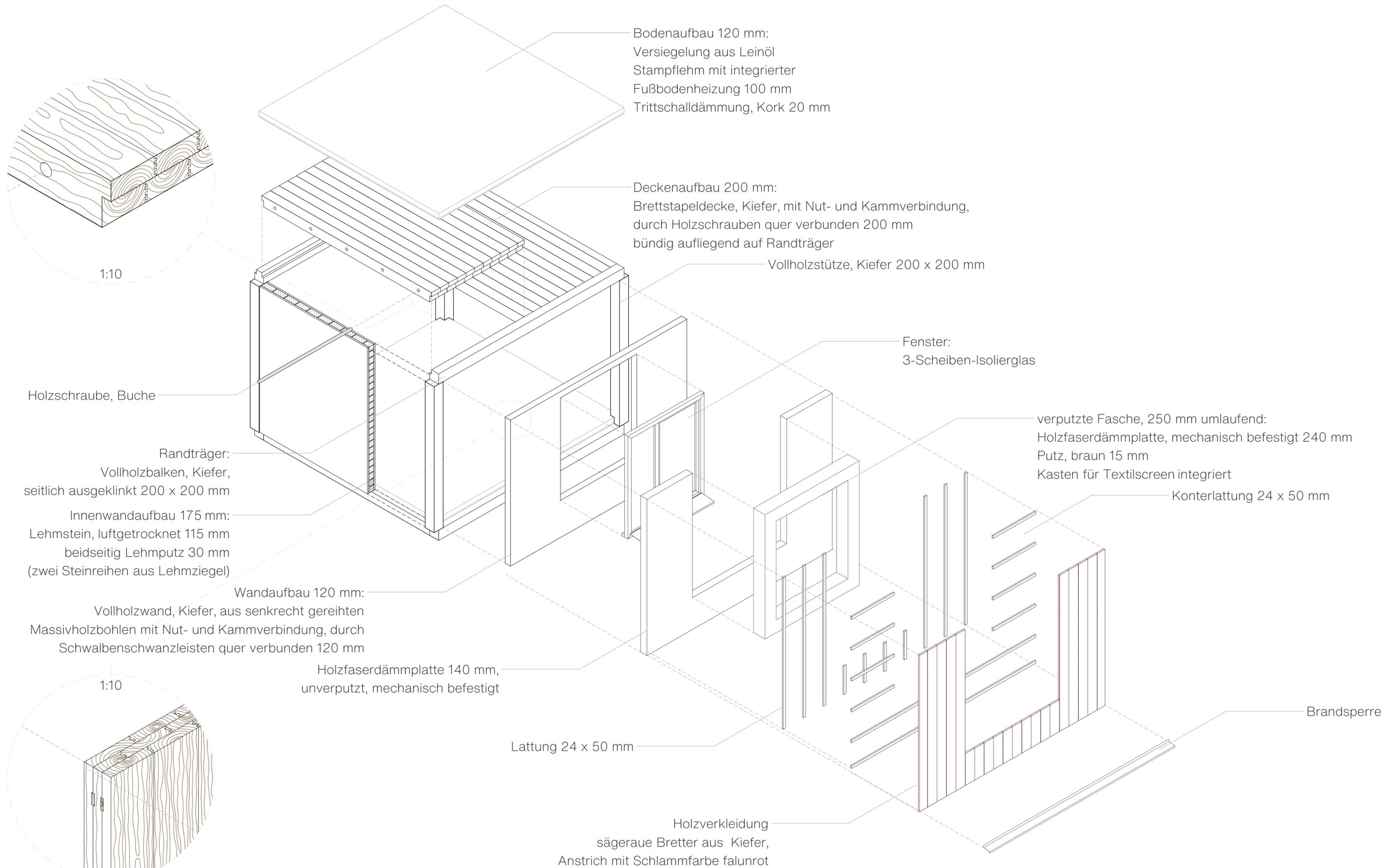
Konstruktionsaufbau der Elemente 1:50
