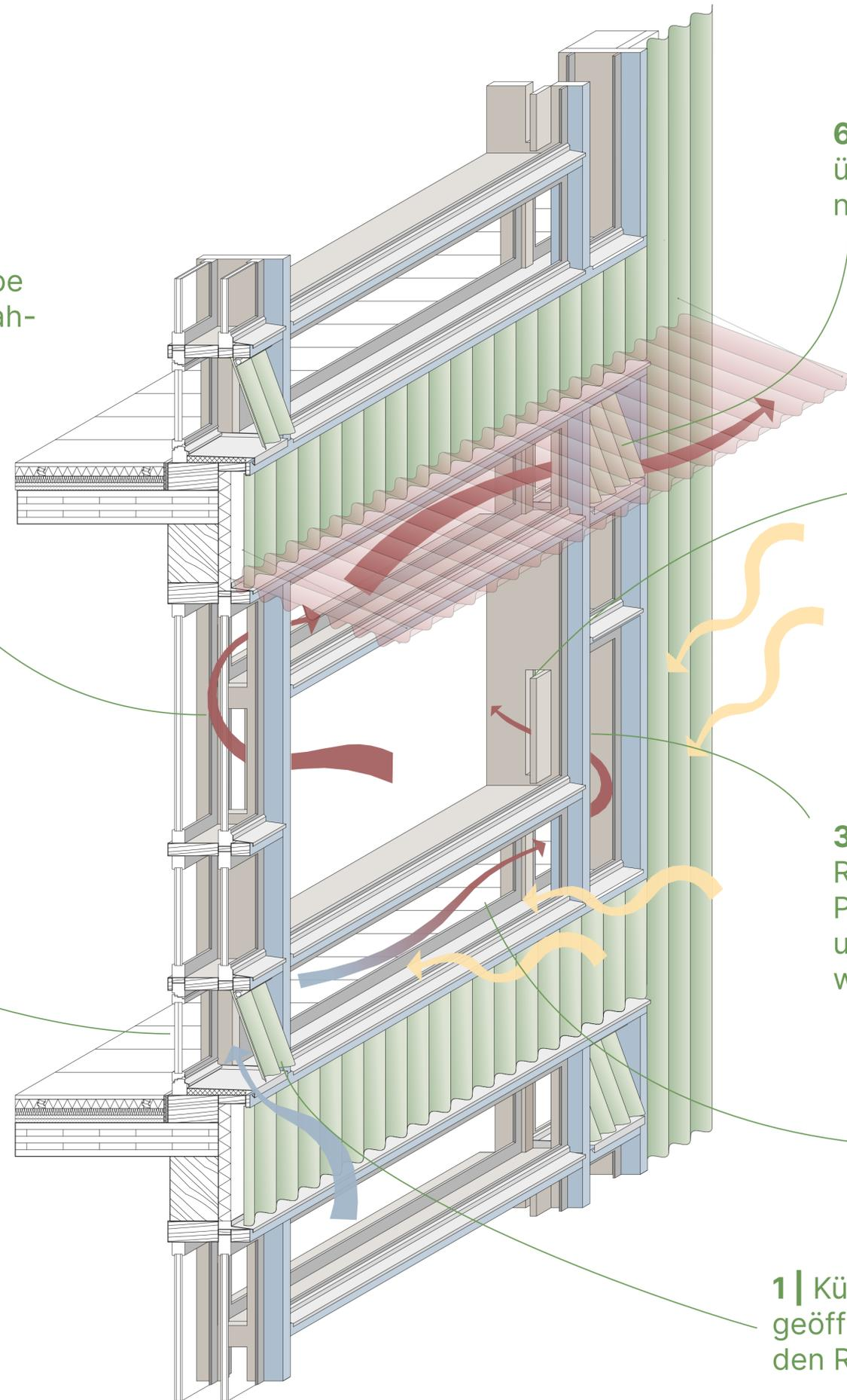
**6** | Die verbrauchte Luft strömt über eine geöffnete Wellblechöffnung aus dem Holzrahmen
