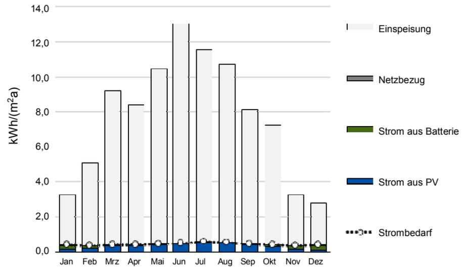
Durch Einspeisung des überschüssigen Stroms ins öffentliche Netz ergibt sich bei einer Jahresbilanz (Enercalc) ein CO<sub>2</sub> neutraler Betrieb.
