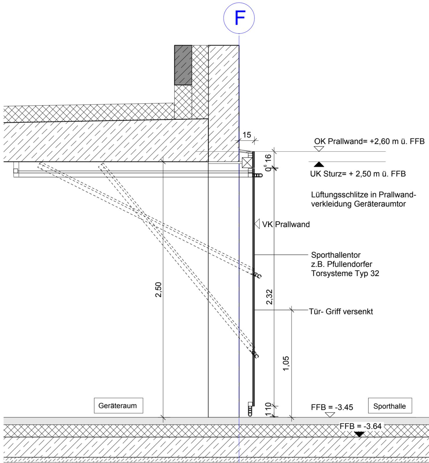
Detailschnitt vertikal M1:20
