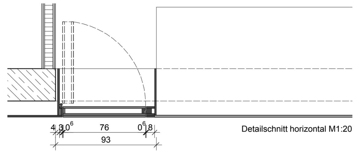
Detailschnitt horizontal M1:20
