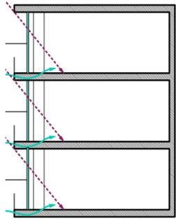
Kältebrücken | Wärmebrücken
