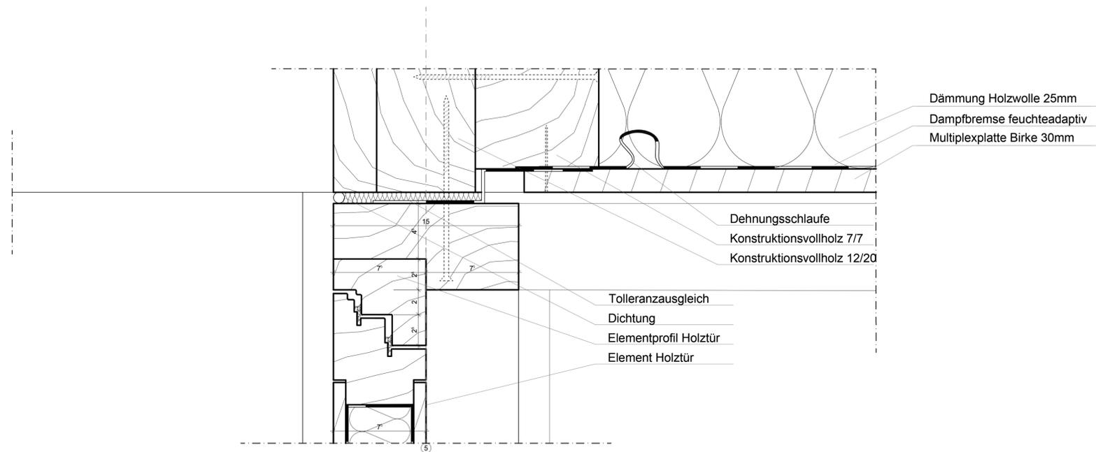
DETAIL 3.2: VERTIKALSCHNITT TÜRELEMENT OBERER ANSCHLUSS M. 1:2
