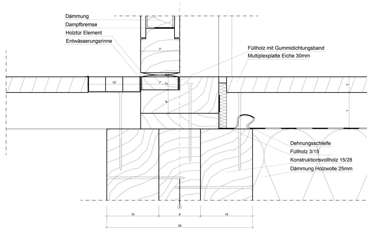
DETAIL 3.3: VERTIKALSCHNITT TÜRELEMENT UNTEN M. 1:2
