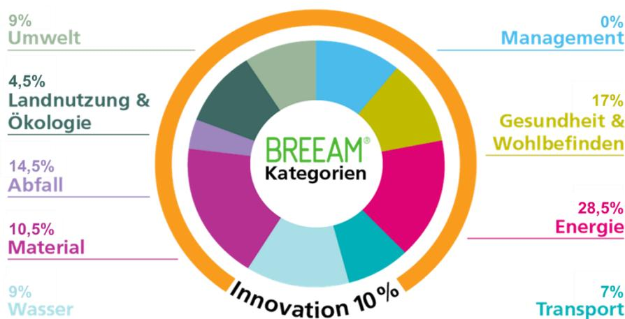
Nach Abschluss der Bewertung nach BREEAM DE Bestand wird das Gebäude in BREEAM-Exzellenzgrade eingestuft. Die Einstufung erfolgt jeweils in Abhängigkeit von der erreichten Nachhaltigkeitsleistung. Für das Objekt ZiHaus wird der BREEAM-Exzellenzgrade „Exzellente“ oder besser angestrebt. Zur Erreichung des gewünschten BREEAM-Exzellenzgrades muss ein Prozentuales Gesamtergebnis >70% erreicht werden. Die hierfür erforderlichen Maßnahmen sind nachfolgenden aufgeführt.
