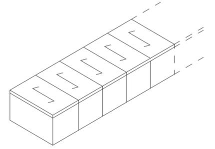
Aussteifung in der Wand mit Stahlprofilen
