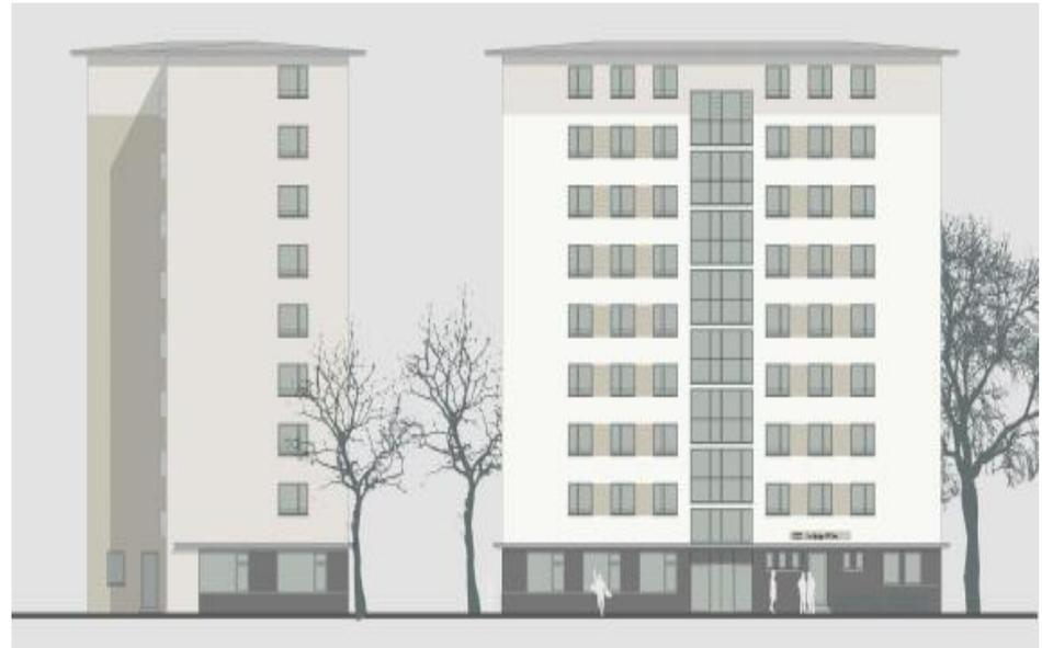
Die Fassaden wurden mit einem mineralischen WDVS System ertüchtigt. Grundlage für die energetische Sanierung ist ein Sachverständigengutachten mit errechneten Dämmwerten der Bauteile.
