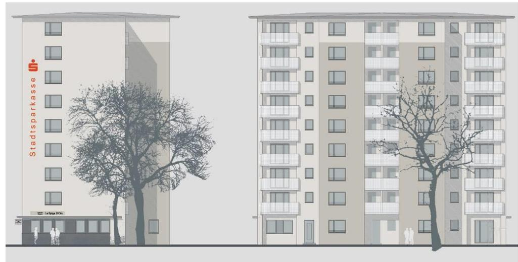
Das 9-geschoßige Wohnhaus mit Kinderkrippe und Gastronomie im Erdgeschoß erhielt im Zuge der energetischen Sanierung Holz- Alufenster mit einer integrierten Wohnraumlüftung. Die Fassaden wurden mit einem WDVS ertüchtigt. Die Balkone wurden erneuert.
