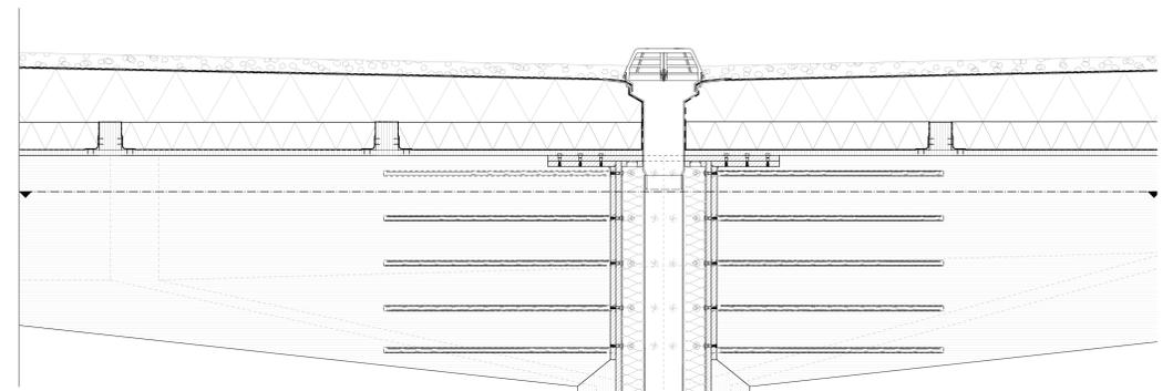
Detail oberer Anschluss Randstütze vertikal
