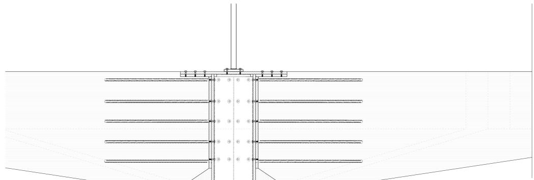
Detail oberer Anschluss Mittelstütze vertikal
