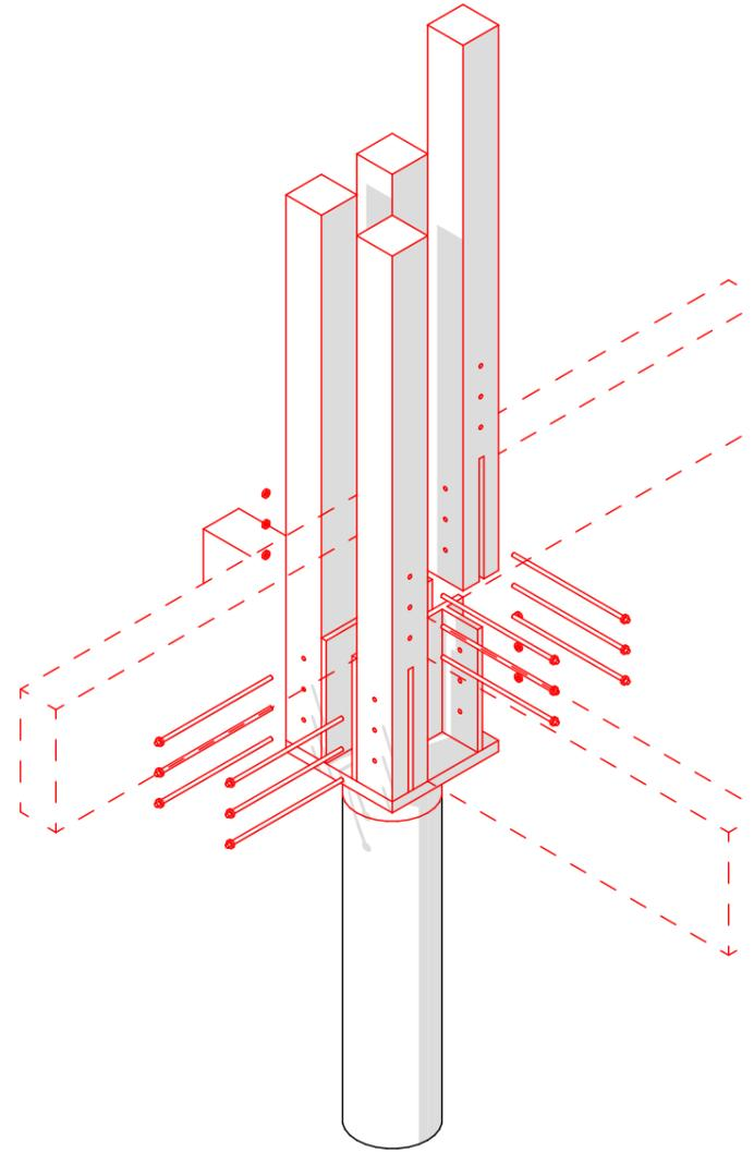
Übersetzung Stahlbeton - Holzskelettbau
