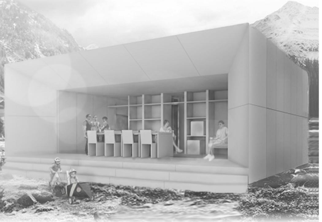
mygreenleaf ist ein modular aufgebautes, energieautarkes Solarhaus. Die beiden transportablen Gebäudemodule von 9,00 m x 3,00 m werden auf der Baustelle zusammengefügt. Die Photovoltaikanlage die sich wie ein Band über die Schmalseite der Außenwände und der Dachzone zieht, lässt das Gebäude wie eine Einheit erscheinen.
