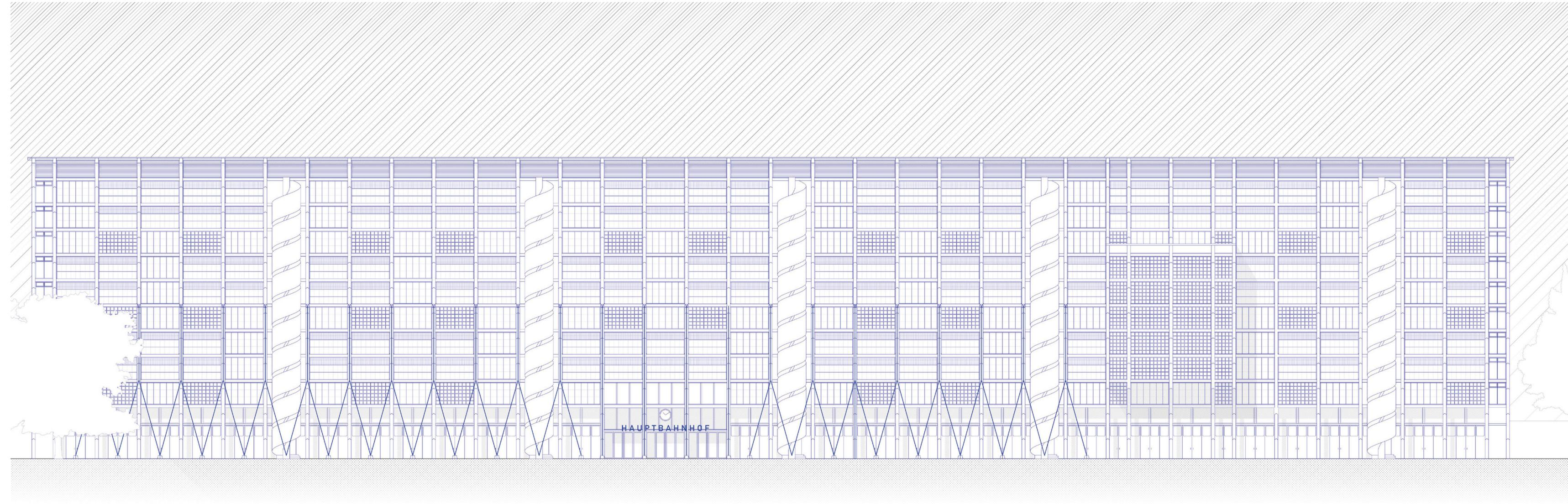
Ansicht Süd M 1:200 Die Zwillinge bilden nach Süden zur entstehenden Bahnstadt das Entree zum Bahnhof und dem Rest der Stadt. Die Ansicht wird durch wiederkehrende Elemente gegliedert und durch Ausnahmen wie das hervorstechen der Brücke aufgelockert.
