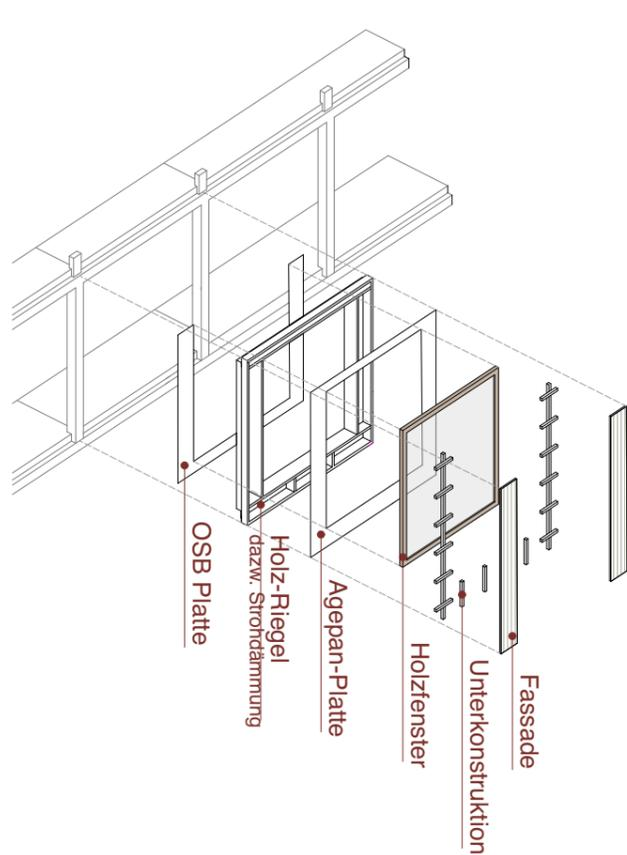
Aufbau des Fassadenmodul
