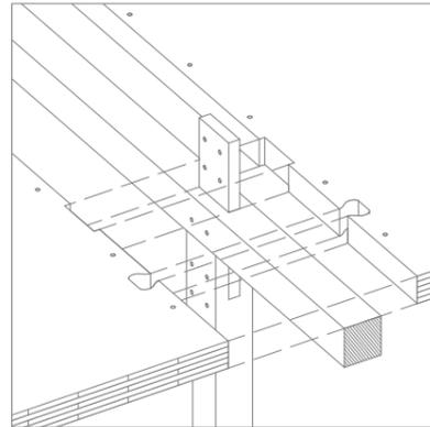
2. Buchendübel verbindet Unterzug am Verbindungselement der Stütze + BSP-Decke wird eingelegt
