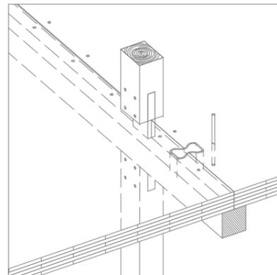
4. Verbindung der BSP-Decken mit X-Fix C + Befestigung mit Buchendübeln am Unterzug
