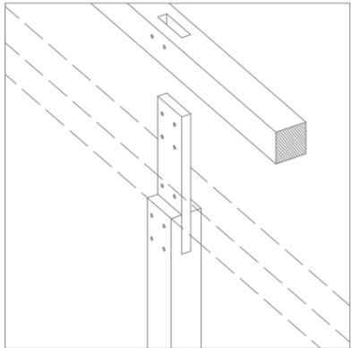
1. Stütze und Verbindungselement werden durch Buchendübel verbunden + Unterzug wird eingefädelt
