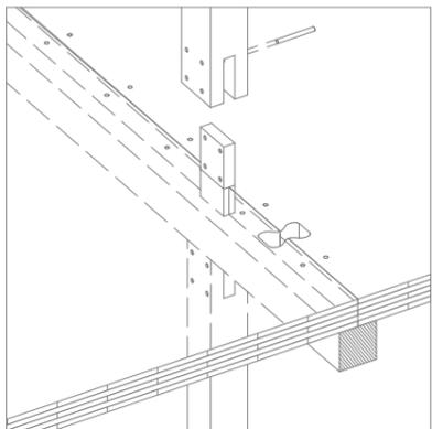
3. Decken werden zusammengeschoben + nächste Stütze wird auf das Verbindungselement gesteckt
