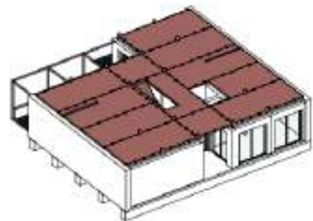
9. Massivholz Decken + X-Fix C + Stiege
