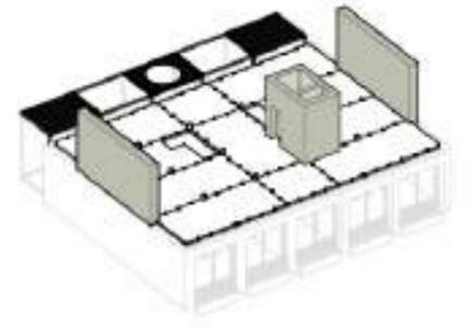
9. Rückbau der Kerne und Brandwände
