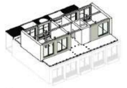
6. Entnahme der Außenwand-Module
