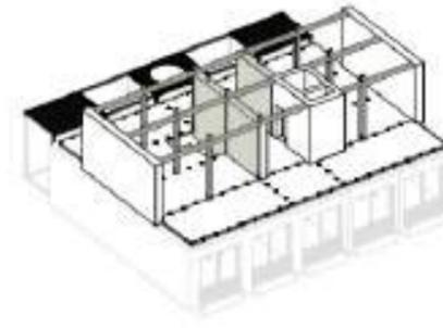
7. Abziehen der Unterzüge + Rückbau der Stiegengauswände
