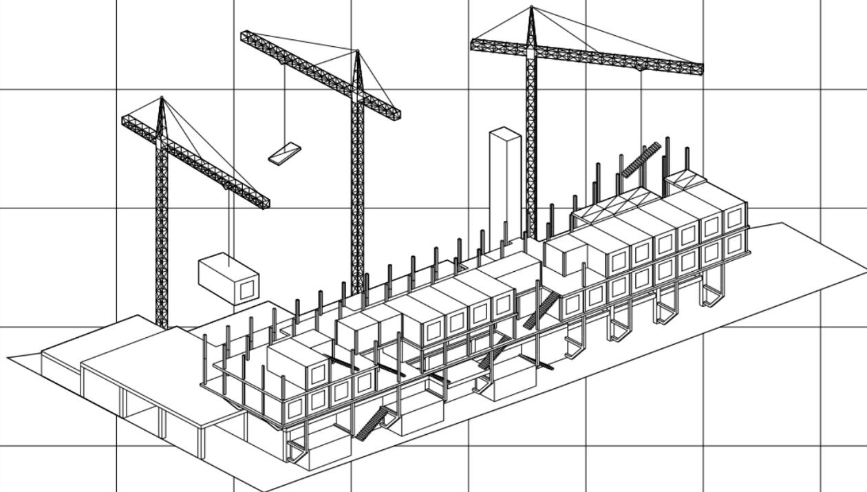
Die 56 Wohneinheiten werden als vorgefertigte Holzraummodule stockweise auf eine Stahlbeton-Tischkonstruktion gestapelt. Die restlichen, gemeinschaftlich genutzten Bereiche werden aus Holz-Verbund-Platten hergestellt, die auf einer Stahlkonstruktion lagern.
