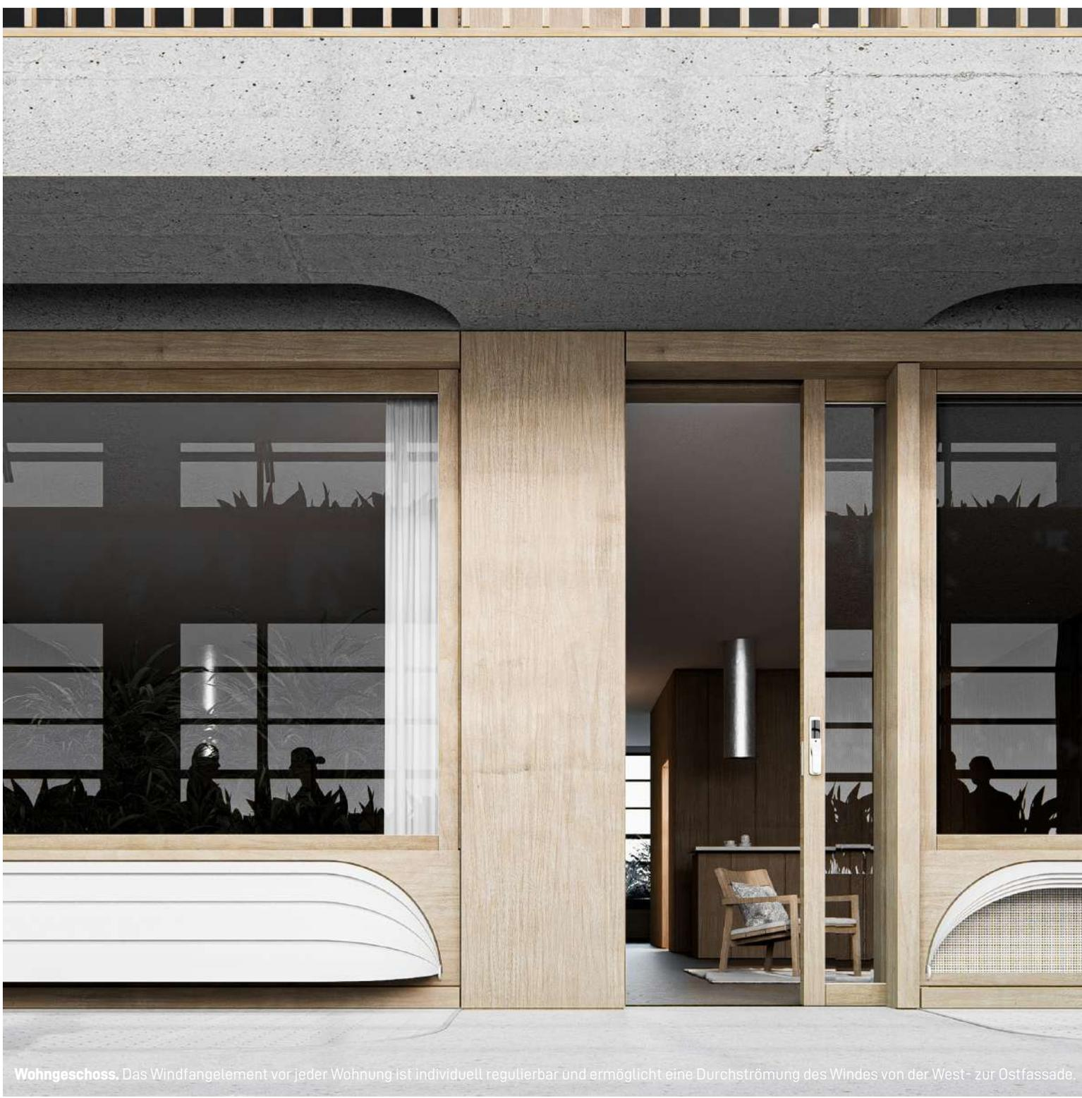
**Wohngeschoss.** Das Windfangelement vor jeder Wohnung ist individuell regulierbar und ermöglicht eine Durchströmung des Windes von der West- zur Ostfassade.
