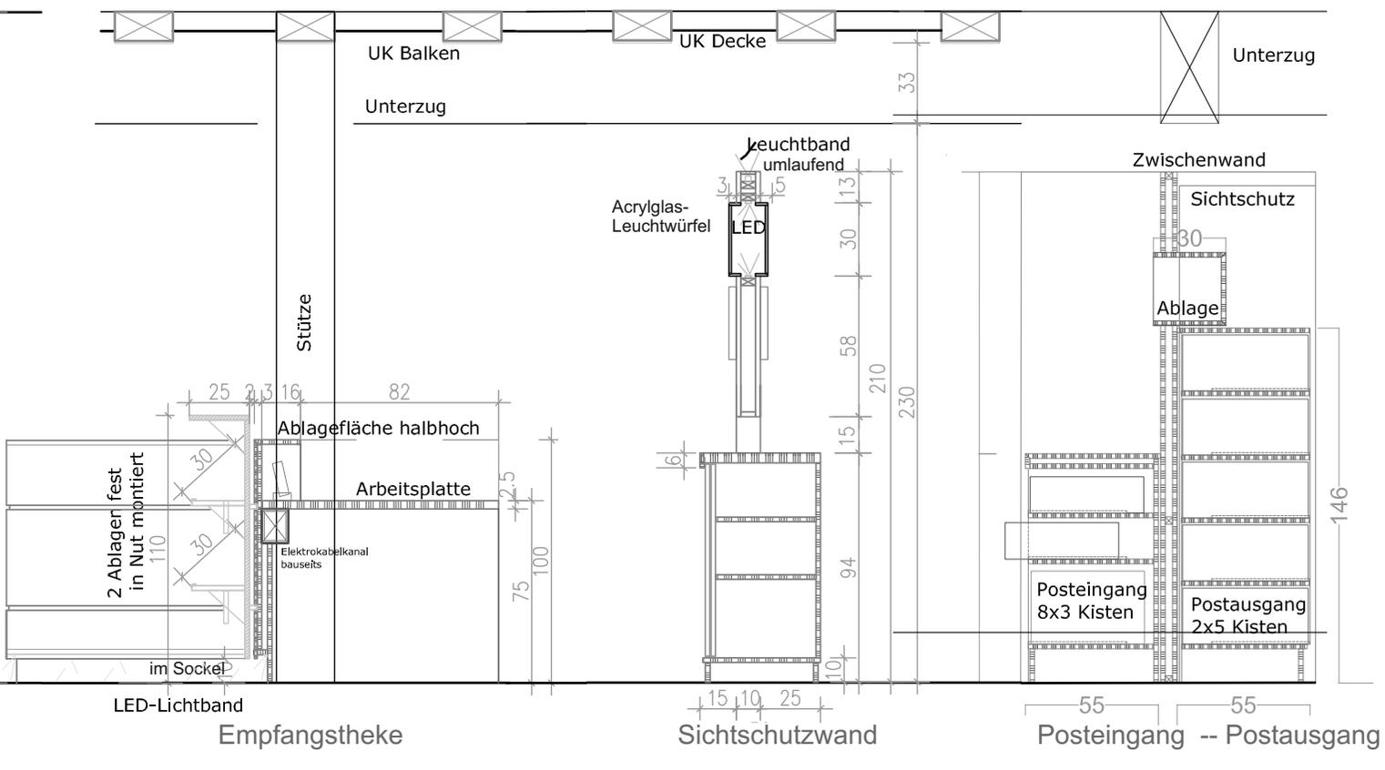
Vertikalschnitte Empfangstheke, Sichtschutzwand, Posteingang und Postausgang - Abbildung ohne Maßstab
