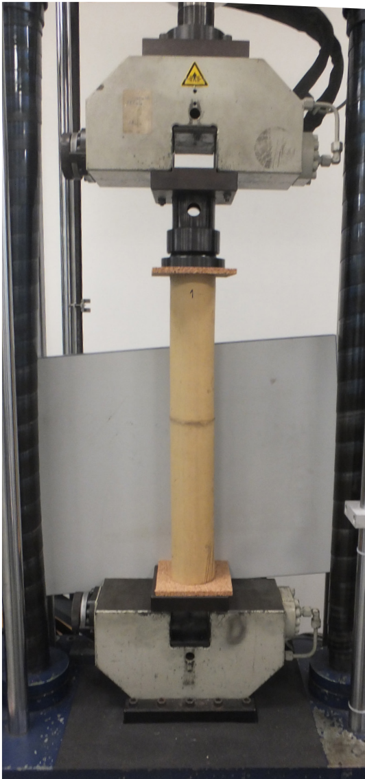
Druckversuch mit Druckstempeln
