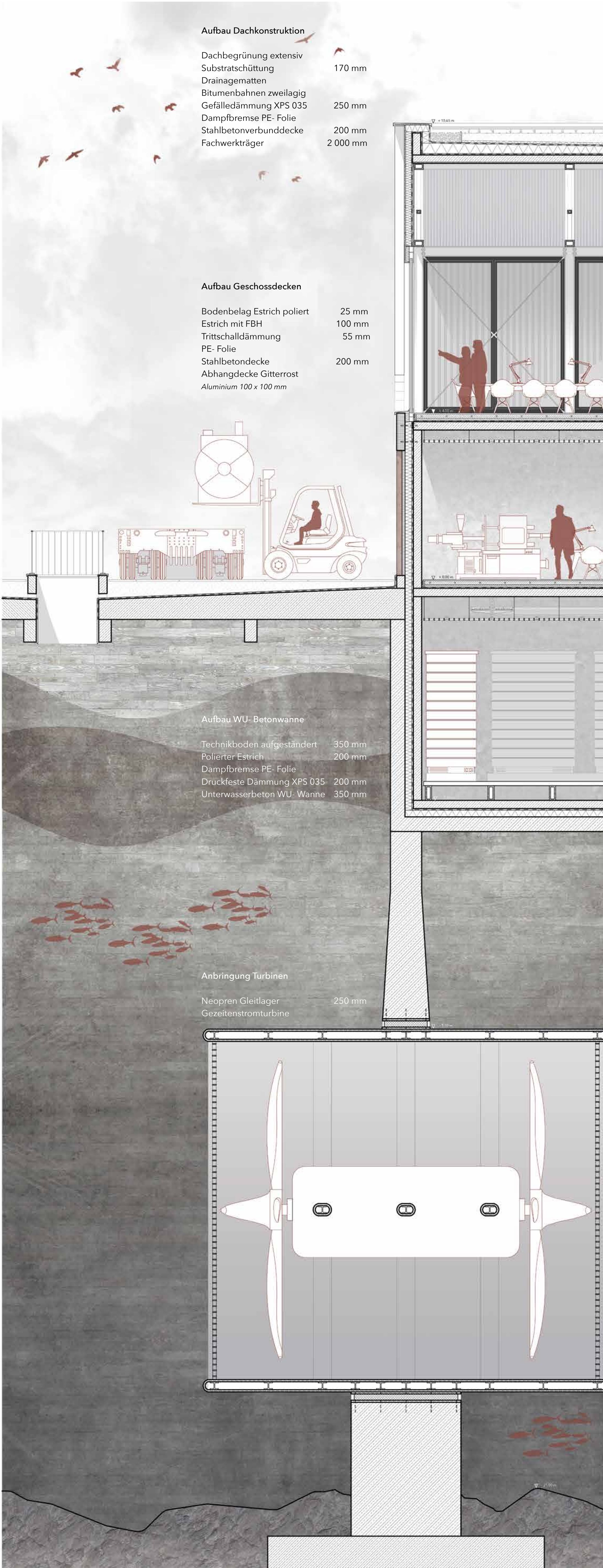
Fassadenschnitt Werkhalle M 1 : 50
