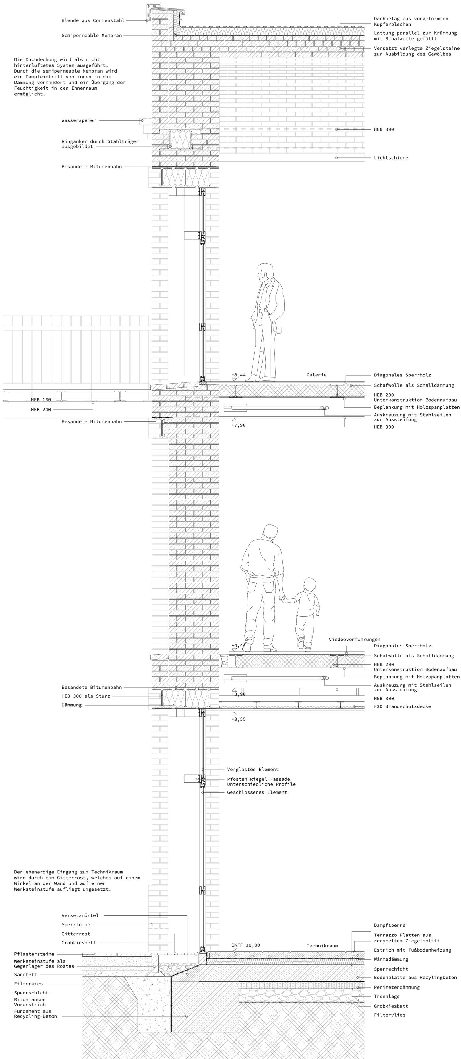
Fassadenschnitt B zur Ausführung des Mauerwerks
