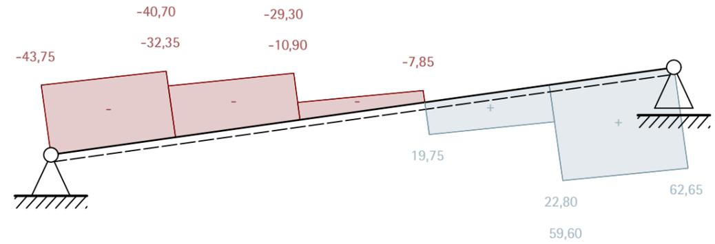
Normalkraftverlauf N | BSH-Hauptträger [kN]
