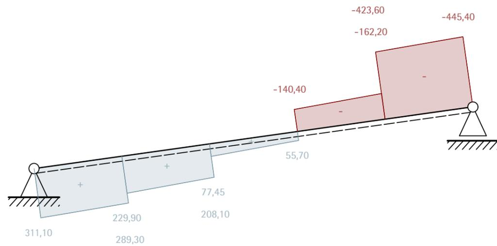
Querkraftverlauf V | BSH-Hauptträger [kN]
