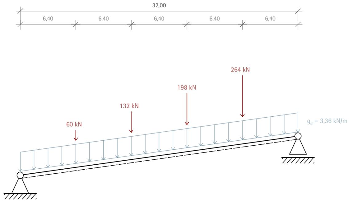
Einzellasten F aus eingehängten BSH-Trägern bestehend aus Eigengewicht, Schnee- und Windlasten.
