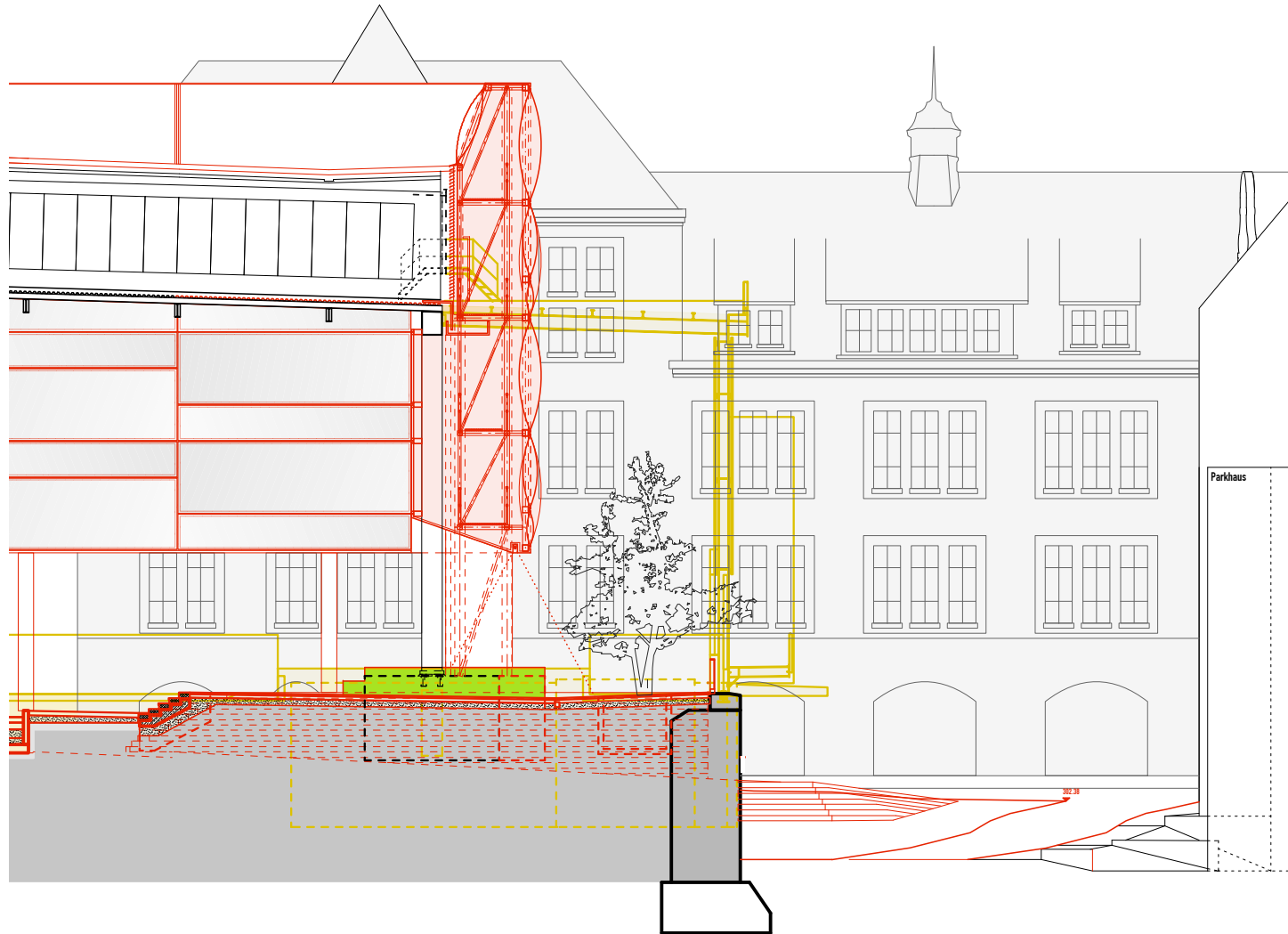
Schnitt Fassade Abriss, M 1:200
