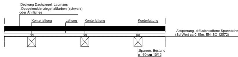
**Querschnitt C - C Dachaufbau im Spitzboden**
