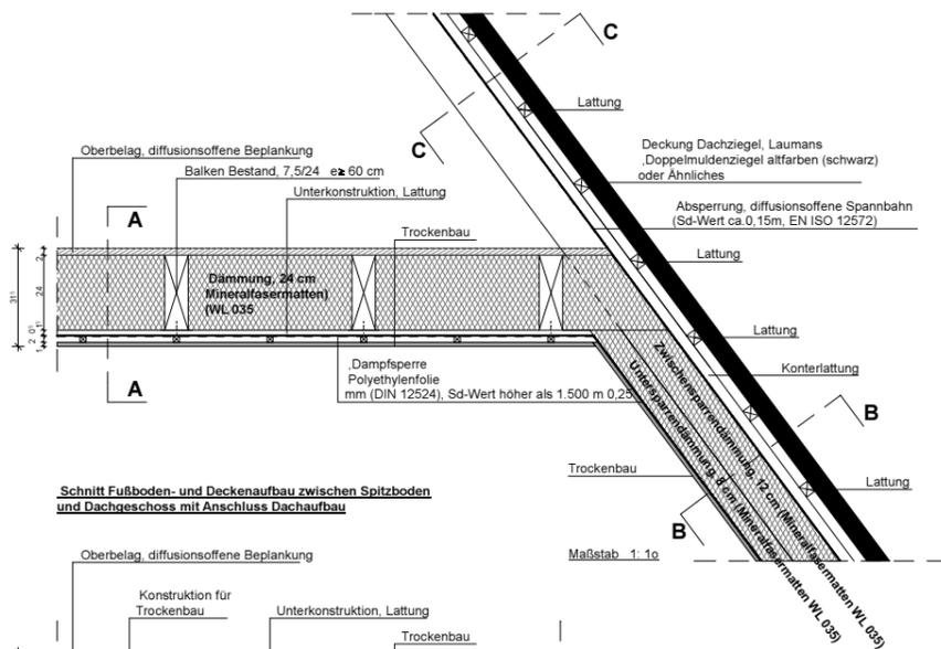
**Schnitt Fußboden- und Deckenaufbau zwischen Spitzboden und Dachgeschoss mit Anschluss Dachaufbau**
