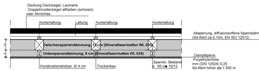
**Querschnitt B - B Dachaufbau im Dachgeschoss**
