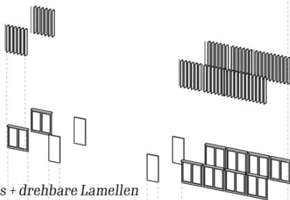
Fassade Flussgeschloss + drehbare Lamellen
