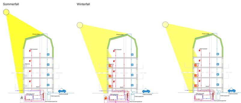
Photovoltaik mit Wärmepumpe (Luft/ Wasser)
