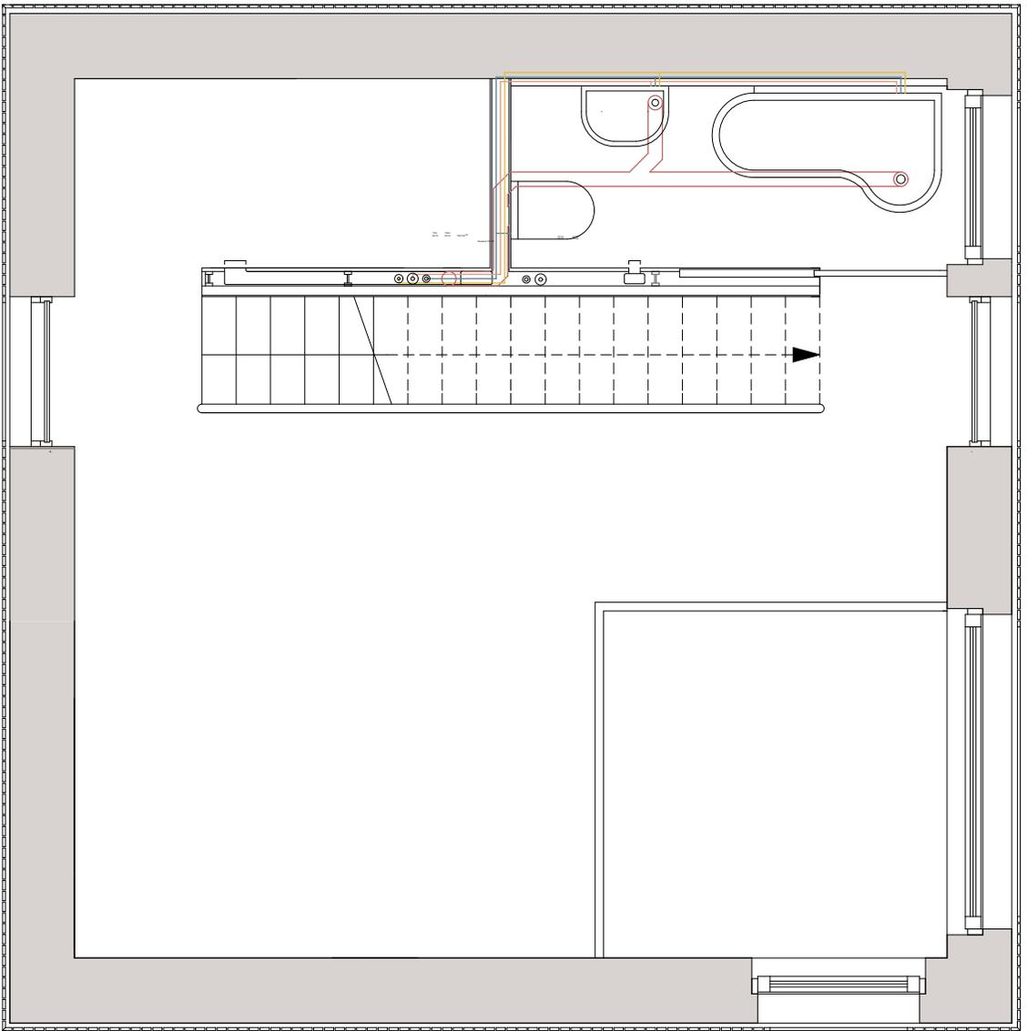
——— Trinkwasser Kalt / Speichervorlauf / HeizungsVorlauf
