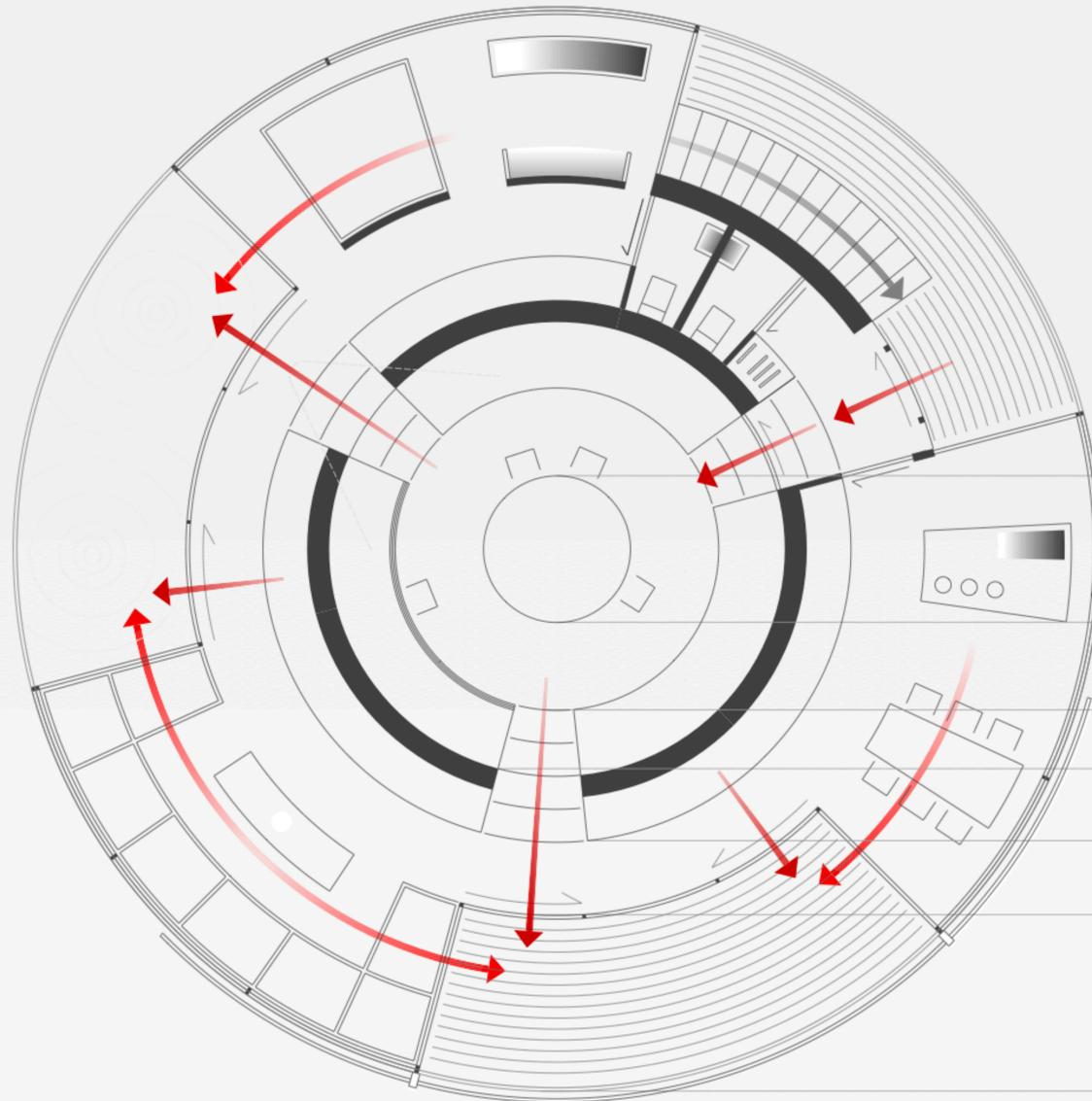
INSIDE OUT KANN SELBST ELEMENTE SCHALTEN UND LÄSST ZAHLREICHE SCHALTUNGEN DER BEWOHNER ZU. SO KÖNNEN FUNKTIONEN DES WOHNEN GESCHALTET WERDEN, KLIMAZONEN VERBUNDEN UND ERSTELLT WERDEN, SOWOHL ALS AUCH DIE SOLARE EINSTRAHLUNG IN DAS GEBÄUDE GESTEUERT WERDEN.
