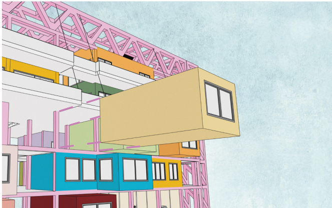
Schiebe-Prinzip der Module
