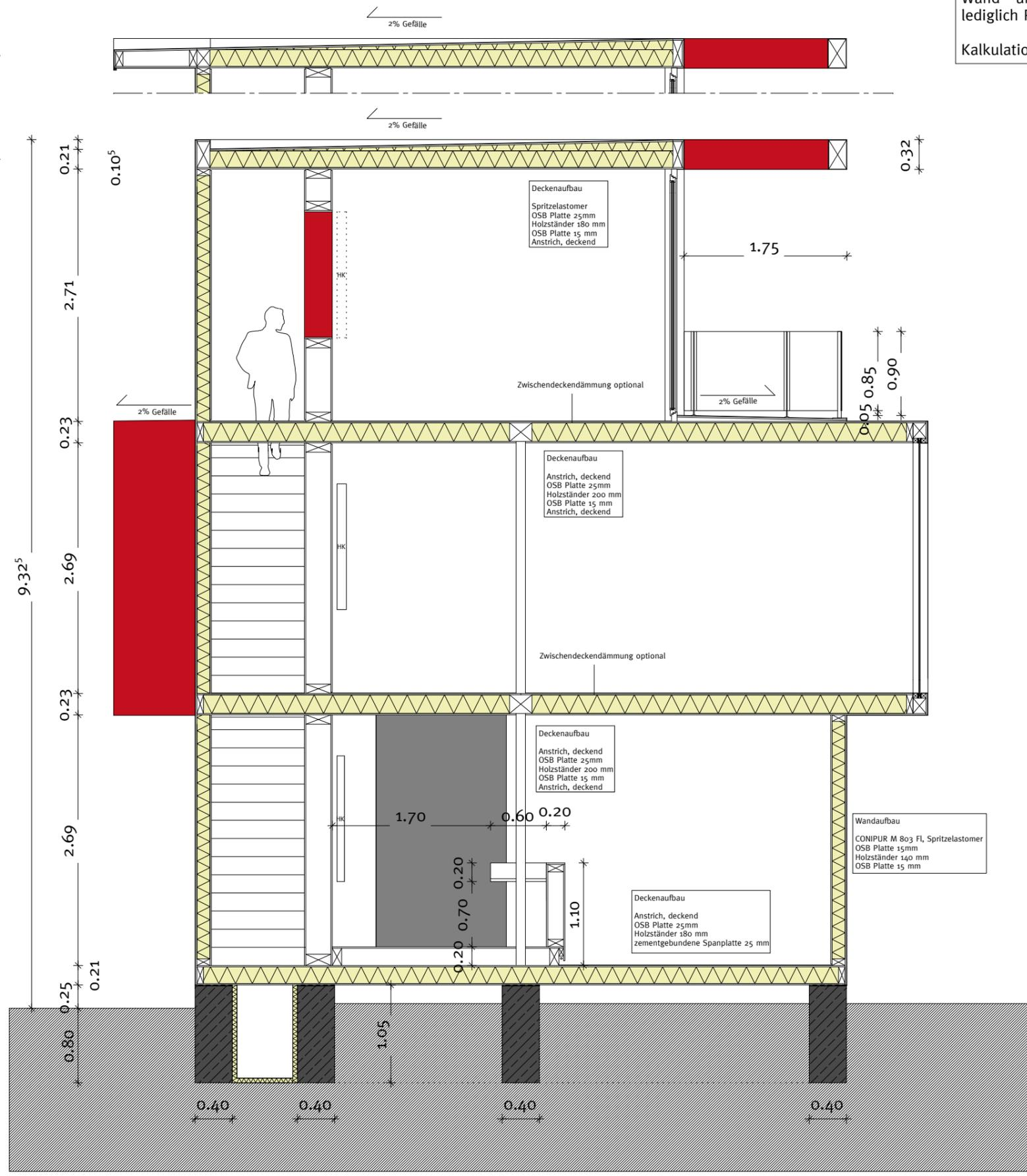
Alle eingezeichneten Hölzer in Wand- und Deckenaufbau sind lediglich Platzhalter !!
