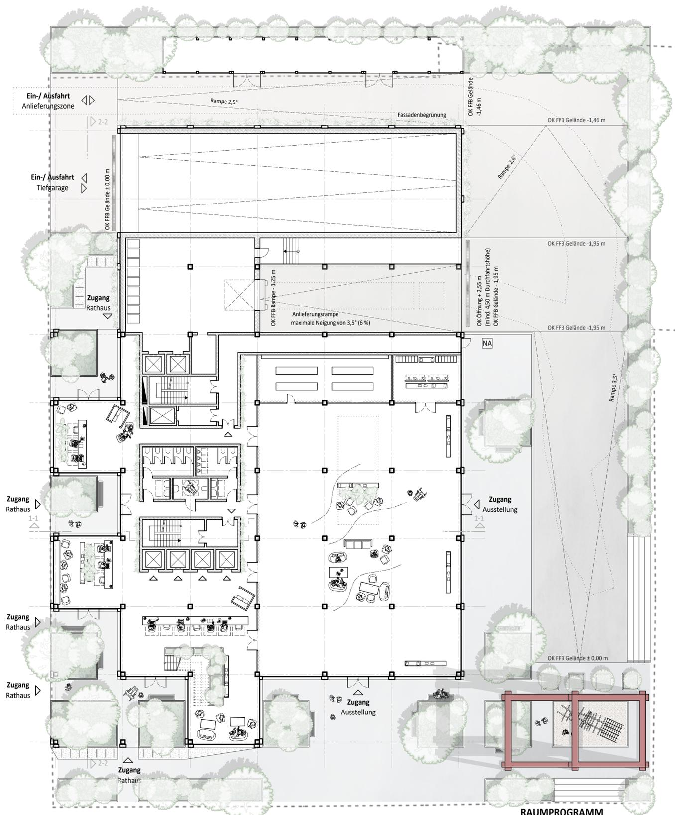
Grundriss | Erdgeschoss mit Außenraumgestaltung M 1:200
