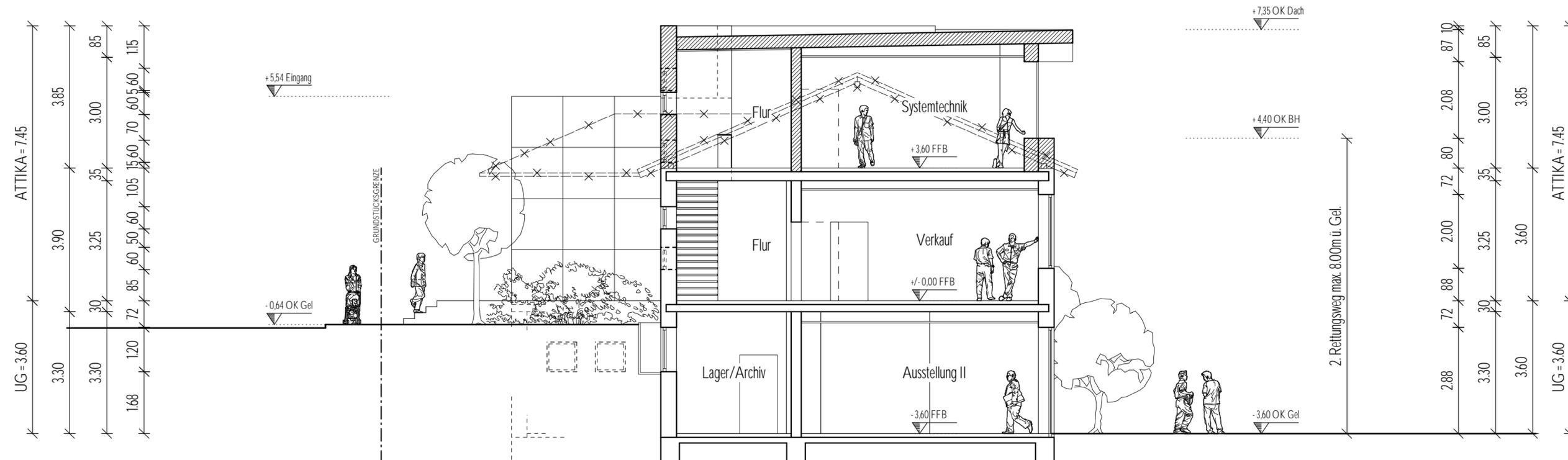
Abbruch des vorhandenen Walmdachs und Aufstockung mit flachgeneigtem Pultdach mit Attika
