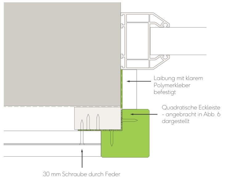
Abb. 11 - Fenster-/Türpfosten mit Eckprofil
