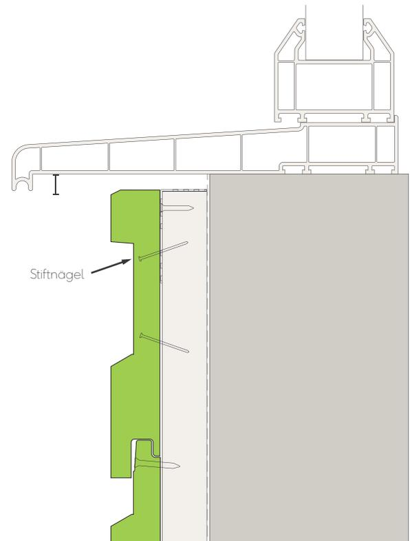
Abb. 16 - Detail Fenster/Türschweller-Verbindung - Stiftnägel
