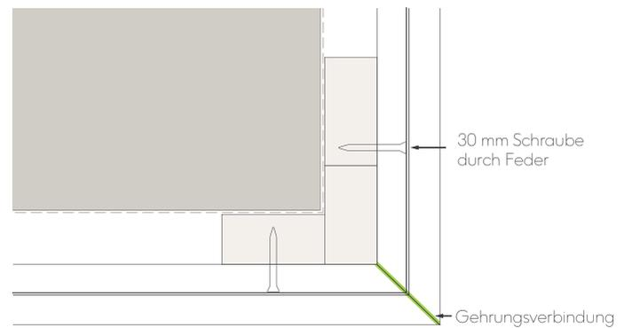
Abb. 10 - Details der auf Gehrung geschnittenen Außenecke
