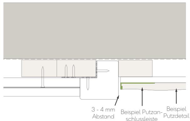
Abb. 20 - Eckprofil stößt an den Putz an
