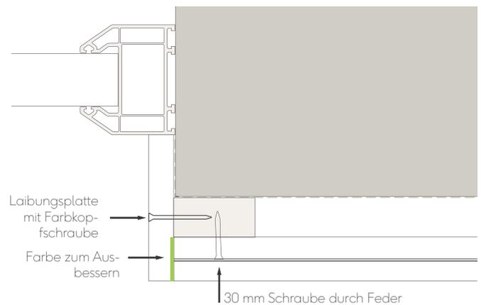
Abb. 15 - Fenster-/Türpfosten mit Laibungsplatte
