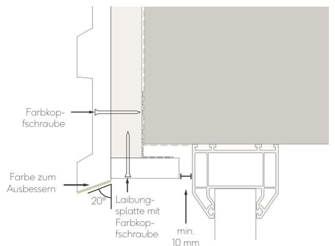
Abb. 13 - Fenster-/Türsturz mit Schrägschnitt
