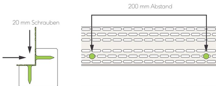
Abb. 6 - Verwendung von Lochblechen an quadratischen Eckprofilen
