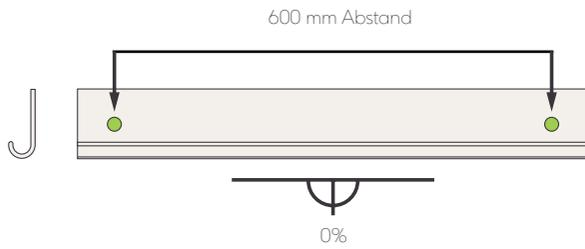
Abb. 17a - Anfangszierleiste montieren
