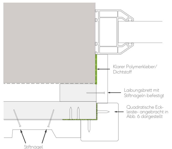
Abb. 15 - Detail Fenster/Türpfosten - Stiftnagel
