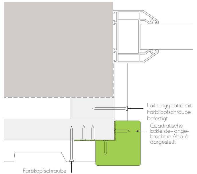
Abb. 11 - Fenster-/Türpfosten mit Eckprofil
