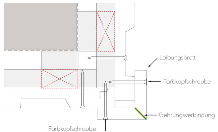
Abb. 10 - Details der auf Gehrung geschnittenen Außenecke
