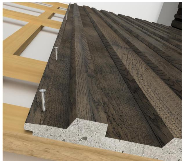
Nachdem das erste Paneel verlegt wurde, kann das zweite Paneel daneben verlegt werden, wobei die Nut die Feder des vorherigen Paneels überdeckt. Prüfen Sie die Paneele nach jeweils 4/5 Paneelen mit einer Wasserwaage, um sicherzustellen, dass die Paneele aufrecht stehen, und passen Sie den Abstand zwischen den folgenden Paneelen bei Bedarf entsprechend an.
