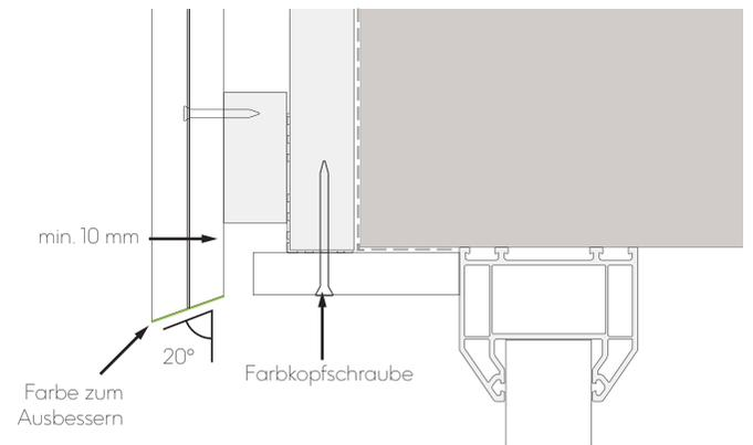
Abb. 14 - Fenster-/Türsturz mit Schrägschnitt
