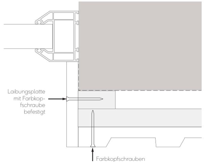
Abb. 13 - Fenster-/Türpfosten mit Laibungsplatte
