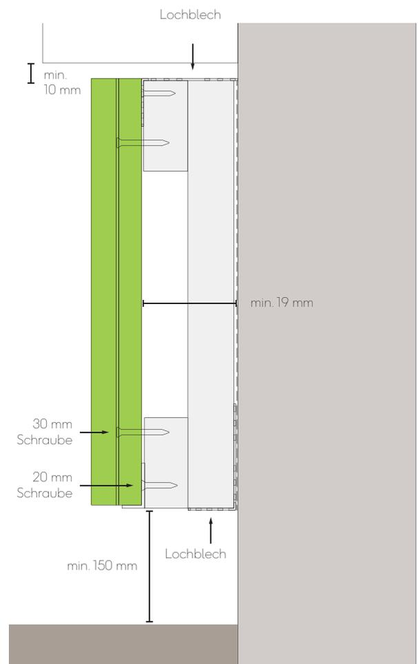
Abb. 1 - Details der oberen und unteren Verkleidung
