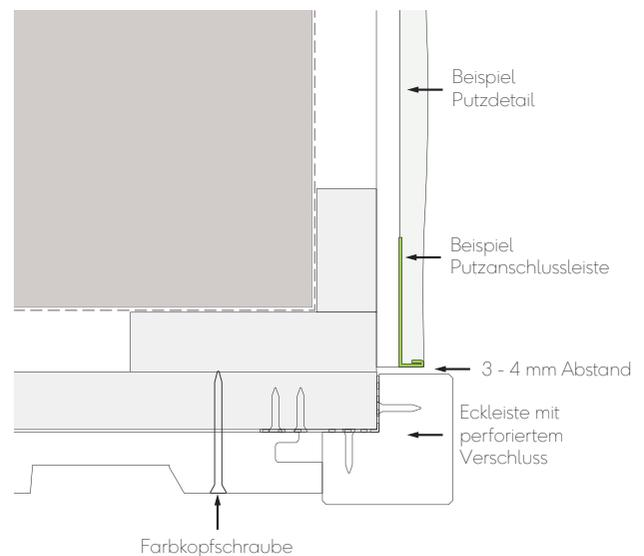
Abb. 20 - Eckprofil stößt an der Außenecke an den Putz an
