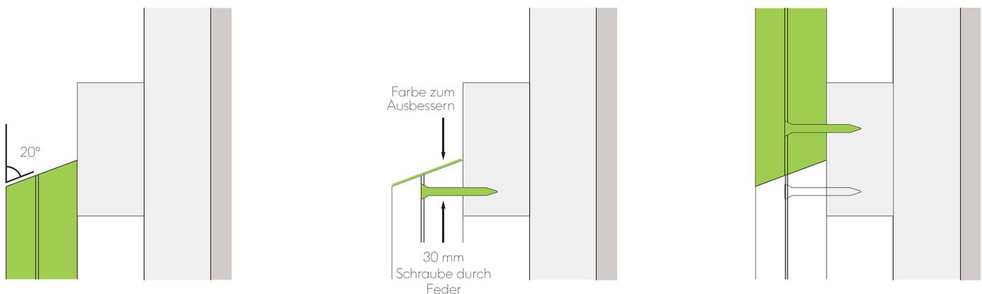
Abb. 18 - Detail zum Verbinden von Paneelen
