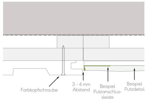
Abb. 19 - Eckprofil stößt an den Putz an
