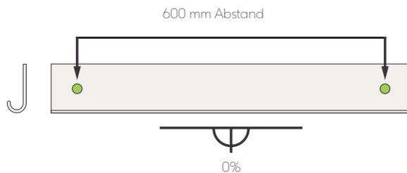
Abb. 18a - Anfangszierleiste montieren
