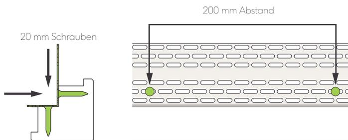
Abb. 6 - Verwendung von Lochblechen an Eckprofilen
