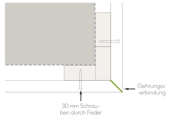
Abb. 10 - Details der auf Gehrung geschnittenen Außenecke
