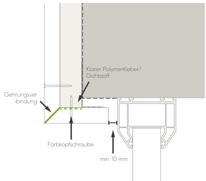
Abb. 14 - Fenster-/Türsturz mit Gehrungsverbindung
