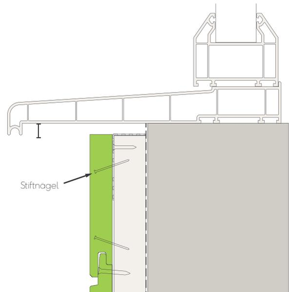
Abb. 16 - Detail Fenster/Türschwellerverbindung - Stiftnägel
