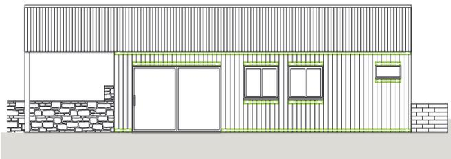
Anzahl an Lochblechen =  $[(\text{Breite der Verkleidungsfläche} \times 2) + (\text{Breite aller Fenster} \times 2) + (\text{Breite aller Türen})] / 3$
