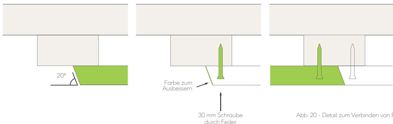
Abb. 20 - Detail zum Verbinden von Paneelen
