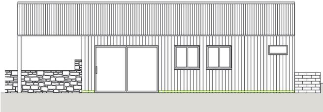
**Lochbleche** werden oben und unten an der Verkleidung und an allen Fenstern sowie oben an den Türen benötigt.
