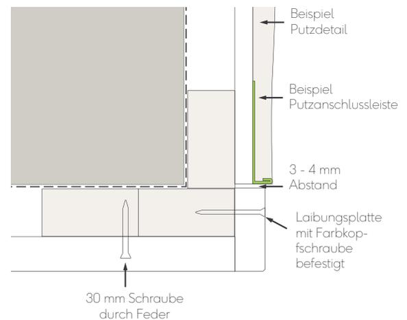
Abb. 22 - Eckprofil stößt an der Außenecke an den Putz an
