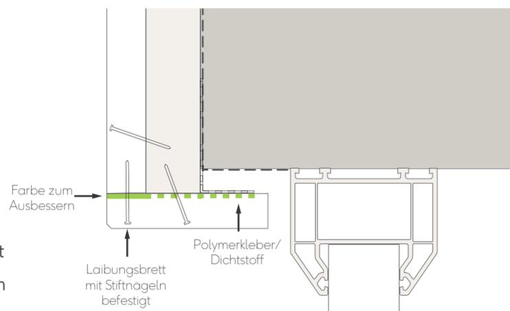
Abb. 17 - Fenster-/Türsturzverbindung mit bündigen Laibungsbrettern - Stoßverbindung und Stiftnägel
