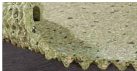
MOGAT Vegetationsmatte EF 35 (100 x 100 x 3,5 cm) aus recyceltem FCKW-freiem PUR-Weichschaum, durchsetzt mit verschiedenen Düngern und Mineralien; dient als Bautenschutz, Drainage, Wasser- und Nährstoffspeicher, untere Substratschicht, Filterschicht.
