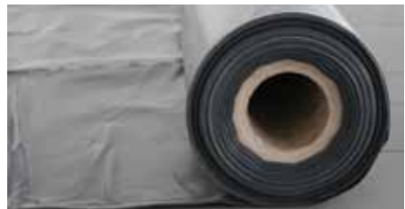
MOGAT Trenn- und Gleitfolie (PE 0,2 mm dick) Stoßüberdeckung 15 cm nach FLL-Richtlinien.
