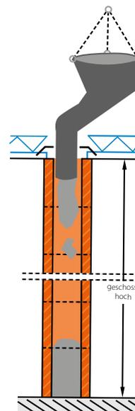
Geschosshohes Verfüllen mit fließfähigem Beton:
