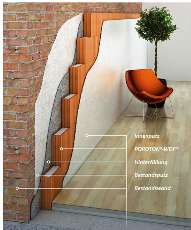
Im Gegensatz zu vielen anderen Dämmsystemen wird die POROTON®-WDF® nicht an die Bestandswand geklebt, sondern freistehend davor aufgemauert. Dadurch werden Probleme durch lose Putzstellen oder Unebenheiten vermieden.
