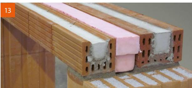
13 Ausbildung von Fenster- und Türstürzen mit Einlegen einer Wärmedämmung WLG 035,  $d \geq 7,0$  cm, Sturzhöhe 11,3 cm.
