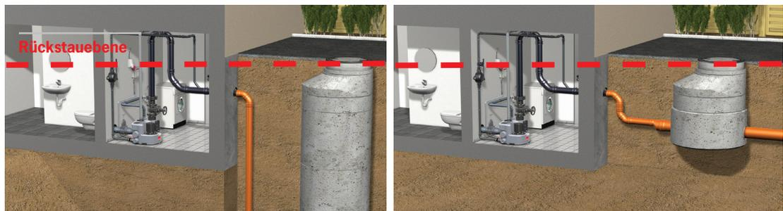
Schutz gegen Rückstau bei Gefälle zum Kanal durch eine Abwasserhebeanlage in Mehrfamilienhäusern, Gewerbeobjekten und Einfamilienhäusern mit Einliegerwohnung
